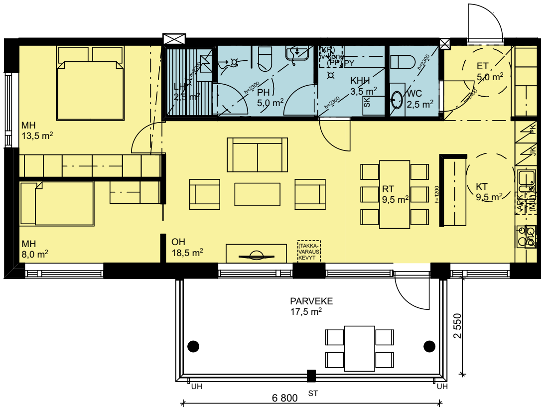
Takkavaraus ylimmän kerroksen asunnossa.
